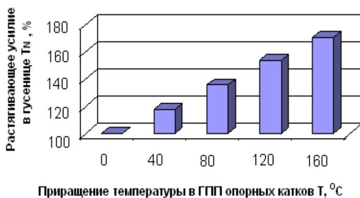
Рис. 5. Диаграмма изменения величины растягивающих усилий в гусеничном обводе в зависимости от теплового состояния ГПП крайних опорных катков
