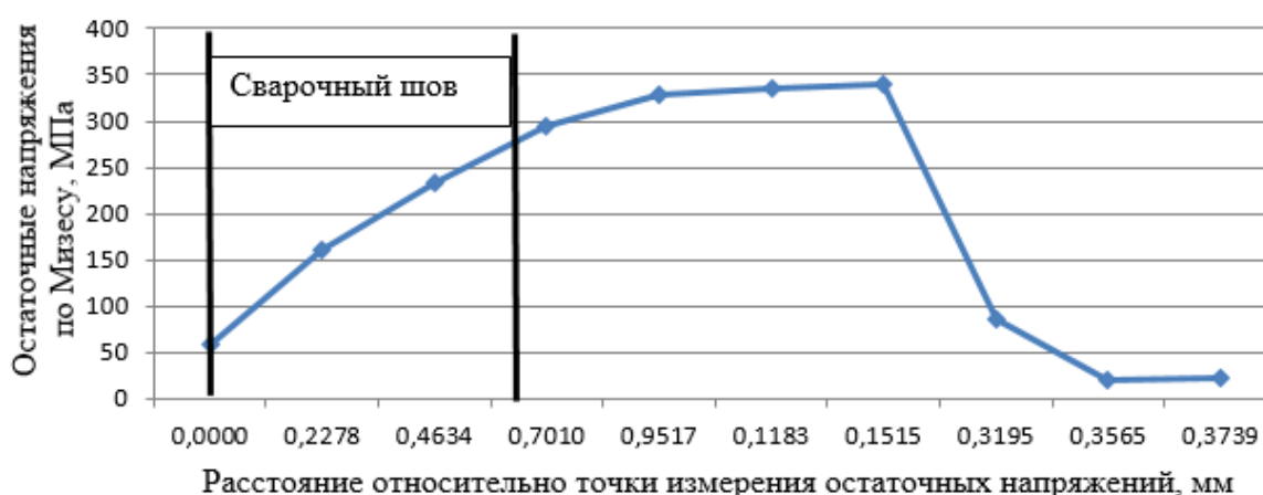
Рис. 7. Напряжения по Мизесу после сварки сегмента обечайки сосуда, расстояние берется суммарно относительно суммы предыдущих точек
