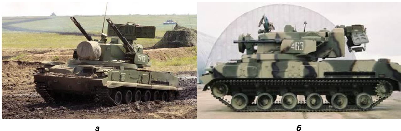
Рис. 3. Военная гусеничная машина с гидропневматической подвеской «Тунгуска»: а – в походном состоянии; б – при всплытии корпуса
