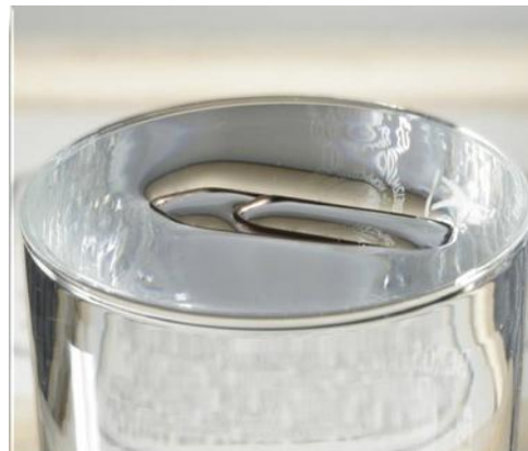
Рис. 2. Нахождение скрепки на поверхности воды
