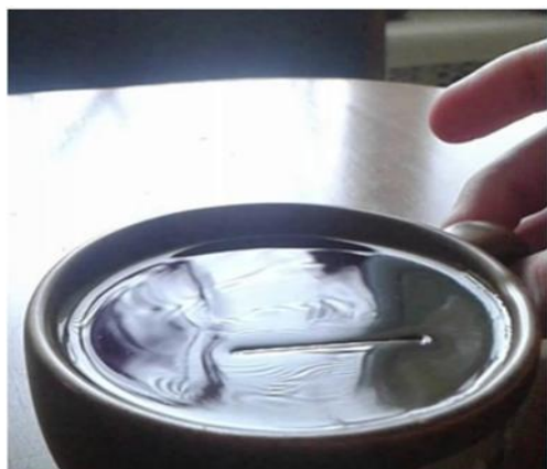
Рис. 1. Плавание иглы на поверхности воды
