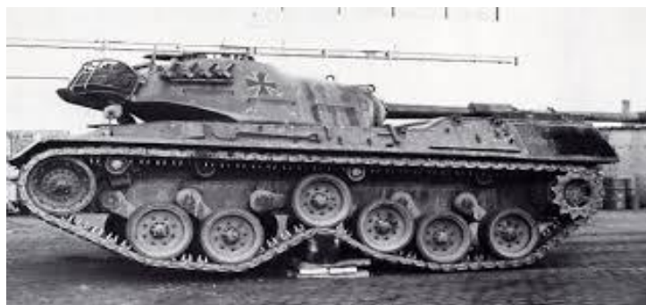
Рис. 2. Работа гидропневматической подвески военной гусеничной машины при преодолении единичного препятствия
