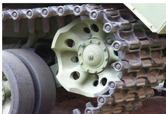
Рис. 4. Устройство натяжения гусеничного движителя: «ленивец», вид общий
